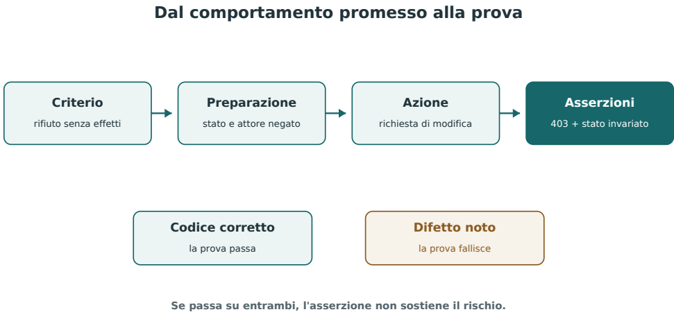
Figura 13.1 — Preparazione, azione e asserzioni derivano dal criterio. La prova controlla risposta ed effetti, perché entrambi appartengono al comportamento promesso.
