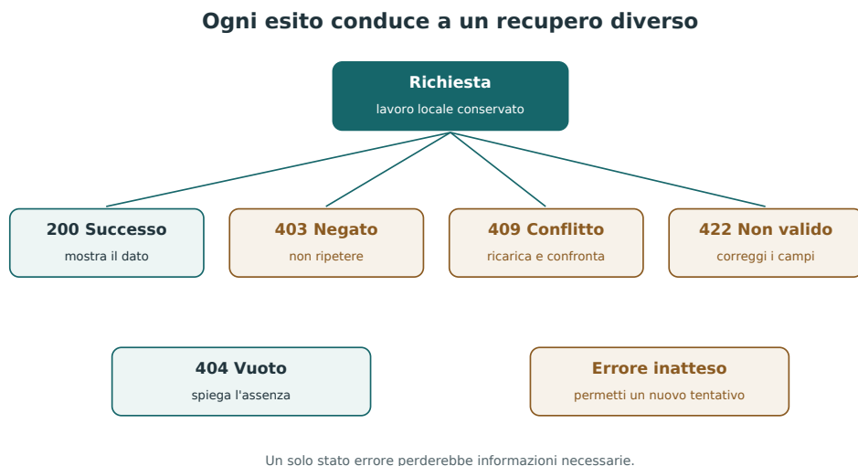
Figura 12.2 — L’esito del servizio determina messaggio e recupero. Ridurre tutti i fallimenti a un unico stato “errore” perde informazioni necessarie all’utente e alle prove.
