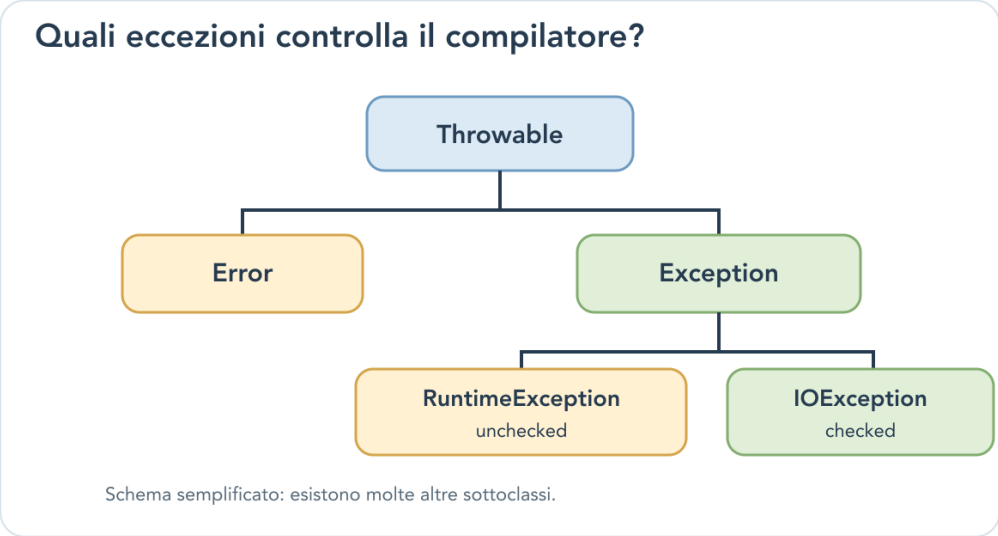
Figura 12.1 – La posizione nella gerarchia determina il controllo del compilatore. Un'eccezione che estende Exception senza essere una RuntimeException è in genere checked ; RuntimeException ed Error sono unchecked .
